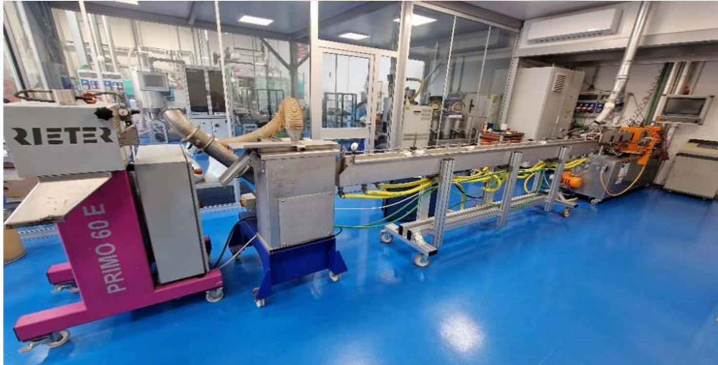
Tutte le formulazioni e i blend sono stati ottenuti con un estrusore bi-vite co-rotante Leistritz ZSE 27 MAXX, caratterizzato da una vite avente diametro di 27 mm e rapporto L/D pari a 40.
