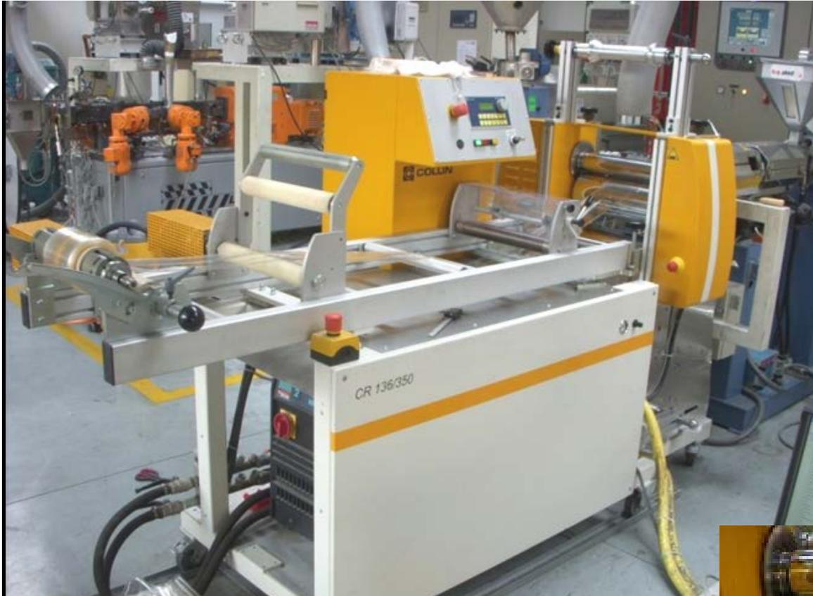
I film sono stati realizzati tramite la linea di estrusione per filmatura cast BGplast SD30, consistente di un estrusore monovite, attrezzato con testa piana (larghezza nominale di 200 mm), ed equipaggiato di un sistema di rulli a calandra (Dr. Collins CR136/350
