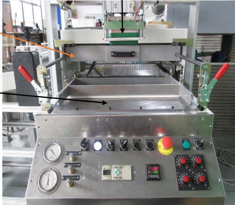
Le prove di termoformatura sono state eseguite utilizzando una termoformatrice O.M.G. srl – modello MA.
