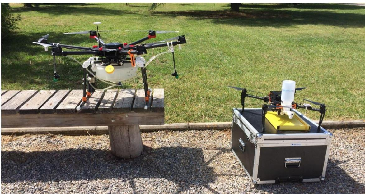
Figura 15. Modelli di droni utilizzabili in agricoltura. Il modello più piccolo a destra è stato uno di quelli utilizzati per la dispersione del polline all'interno degli oliveti.
