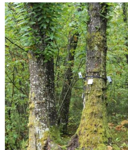
**Assorbimento di carbonio e altre variabili fisiologiche misurati con il sistema IoT dei TreeTalker in un castagneto a diverse intensità di potatura**
