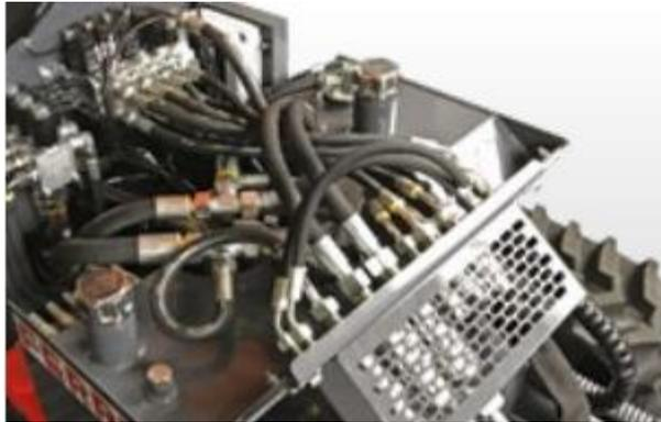
Il sistema idraulico iCut 3 è composto da 4 pompe con circuiti indipendenti:
