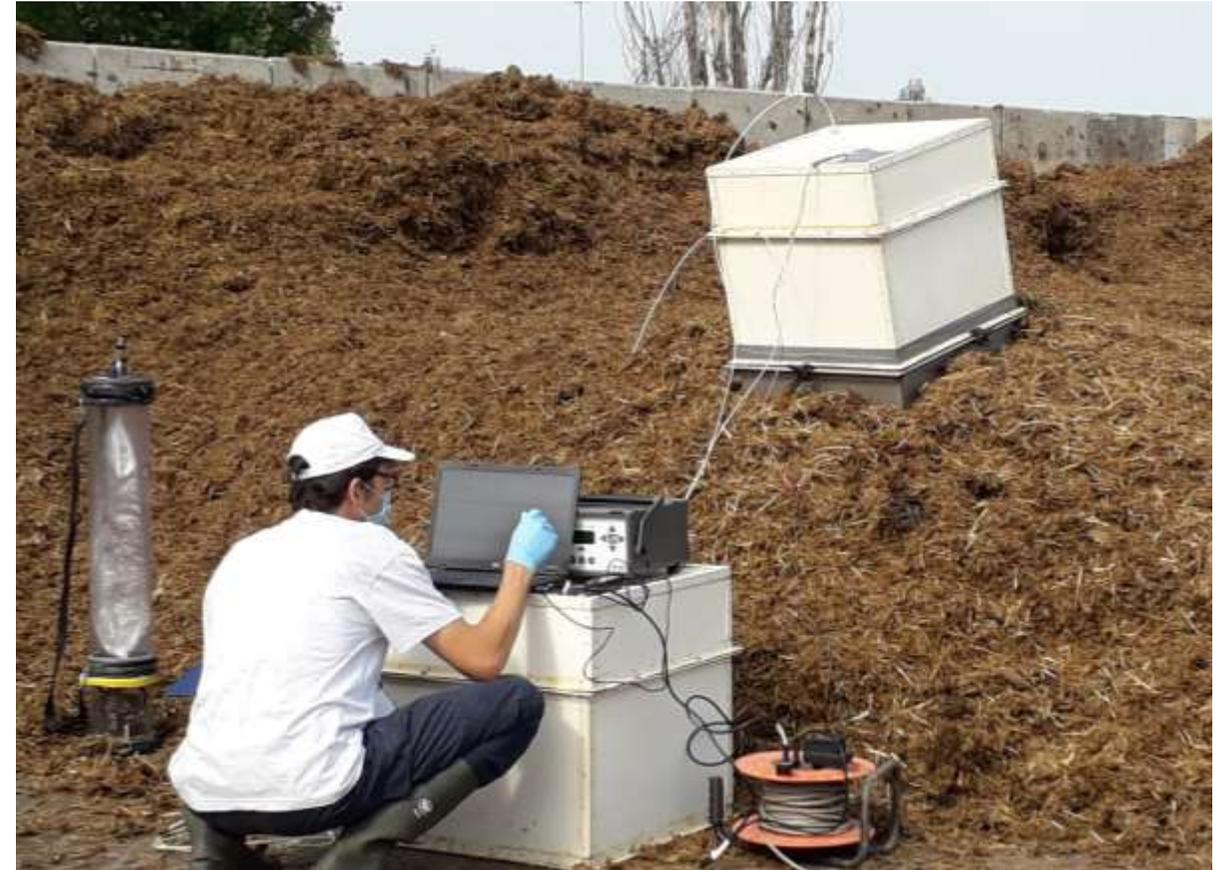
Static Chamber Method (Brewer et al., 1999; Hornig et al, 1999; Pedersen et al., 2001) ed Analizzatore fotoacustico multigas INNOVA + Olfattometria Dinamica, secondo la norma UNI EN 13725:04 con olfattometro TO8 Olfasense
