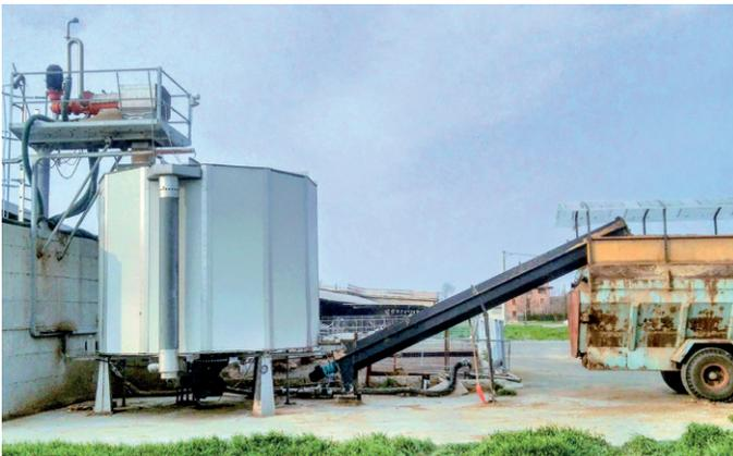
Foto 1 – Prototipo di biocella dinamica igienizzante
