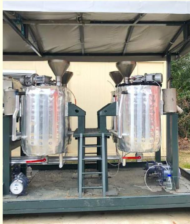
*Reattori anaerobici CSTR per digestione anaerobica degli overflows*
