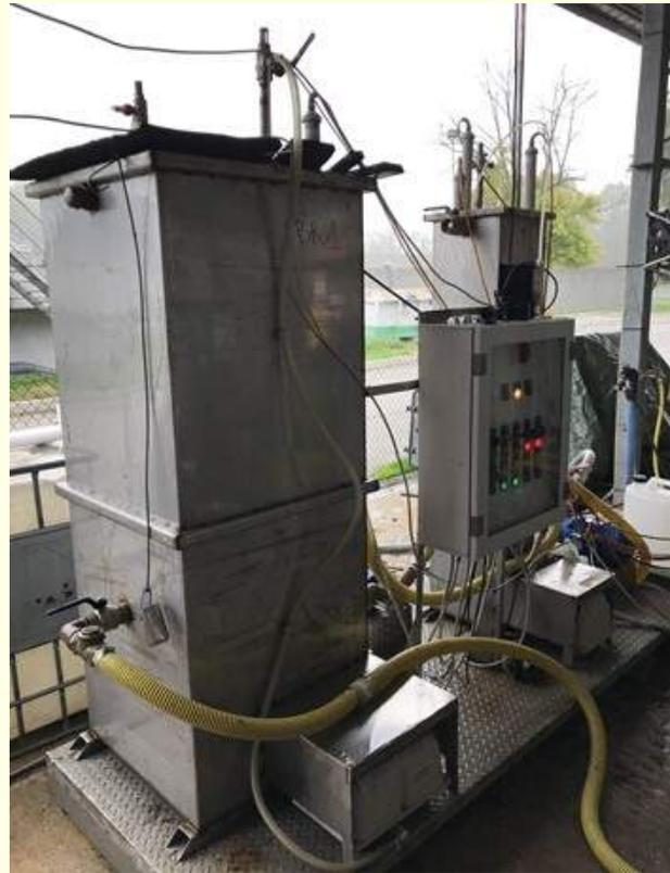
*Reattore anaerobico CSTR per la fermentazione di reflui organici urbani (sinistra) e reattori aerobici (SBR e fed-batch) per la produzione di biomassa PHA-accumulante e PHA intracellulare*
