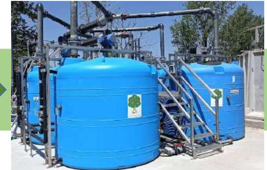
**Quattro reattori** da 7.5 m<sup>3</sup>, miscelati e riscaldati a 30-40°C, riempiti a metà livello. Un flusso d'aria nello spazio di testa rimuove l'NH3 rilasciata dalla superficie del liquido.
