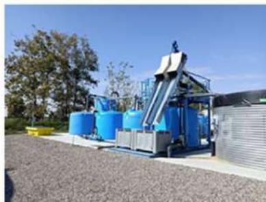
Il progetto si propone di sviluppare una tecnologia innovativa per la rimozione dell'azoto dagli effluenti di allevamento e realizzare un impianto pilota che possa dimostrare la possibilità di introduzione del sistema nelle aziende zootecniche.
