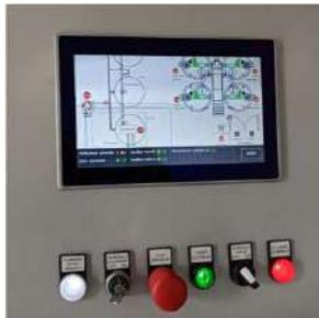
L'impianto è monitorato e controllato da un **PLC**, accessibile anche da remoto.
